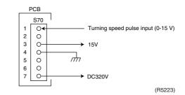
\* Propeller fan motor : S70
