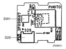
PCB(3): Buzzer PCB
