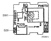
PCB(3): Buzzer PCB
