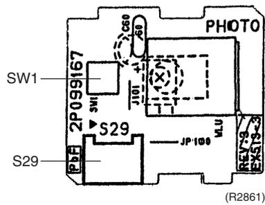
PCB(3): Buzzer PCB
