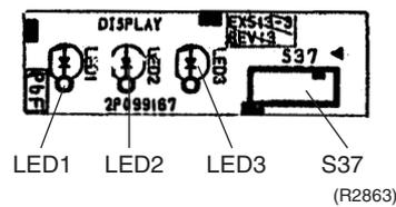
PCB(5): INTELLIGENT EYE sensor PCB
