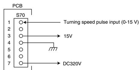
\* Propeller fan motor : S70
