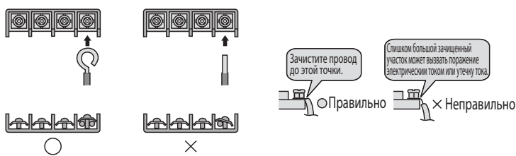
Зачистка провода на клеммной колодке
