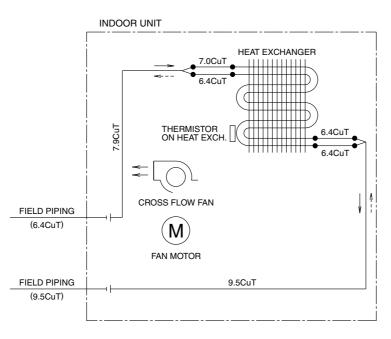
REFRIGERANT FLOW ----> COOLING ----> HEATING
