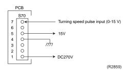
\* Propeller fan motor : S70
