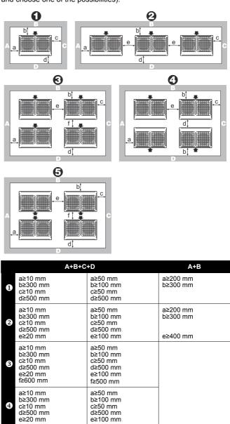
$h_2$  $h_1 > 0 \rightarrow b \ge b + \frac{h_1}{2}$ h<sub>1</sub> 500 F 500  $h_2 > 0 \rightarrow d \ge d + \frac{h_2}{2}$
